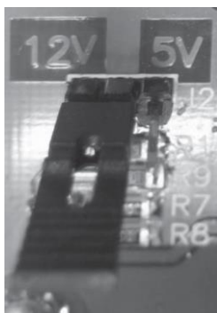
Position 12V (à associer avec le convertisseur 12V)
